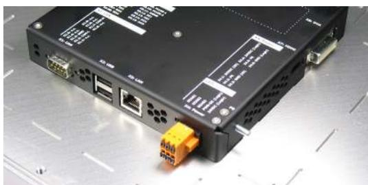
Die E1/K1 Controller sind neben den Standalone-Varianten für die Schaltschrankmontage auch als Systemeinheiten für L1/C1 Panels verfügbar. In dieser Kombination können E1/K1 Controller als Touch-PLC oder Web-Panel eingesetzt werden. Die xE- oder xK-Systemeinheit wird dazu einfach auf der Rückseite des Panels montiert. Display, Touch, USB und Spannungsversorgung werden über die standardisierte mechanische und elektrische Schnittstelle geführt.
